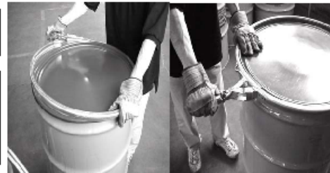
Figura 7 – Alina el Anillo para Ser Instalado
